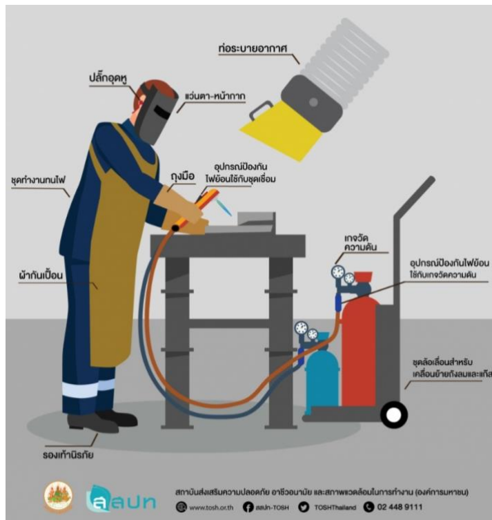
รูปที่ 20. แสดงภาพตัวอย่างในการทำงานเชื่อมแก๊ส (Gas Welding)
